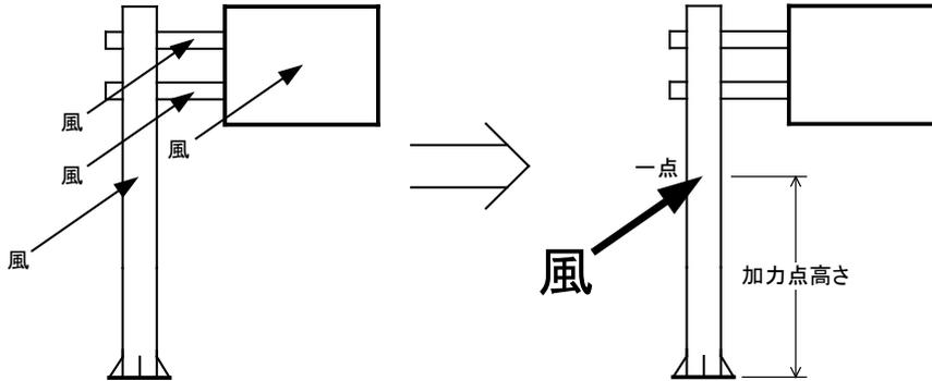
道路附属物は色々な場所に水平力（風）を受けます。例えば標識柱ならば標識板、梁、柱に受けます。「水平力×それぞれの高さ」の合計が全体の曲げモーメントとなります。これをもし、水平力が一点にかかるとした時のモーメント高さはどこか？というのが、加力点高さです。
