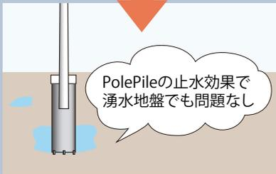
崩壊・湧水地盤では、湧水対策・土留枠設置など大変です。PolePileなら写真のように止水・土留効果を発揮するため、施工時に余計な手間がかかりません。
