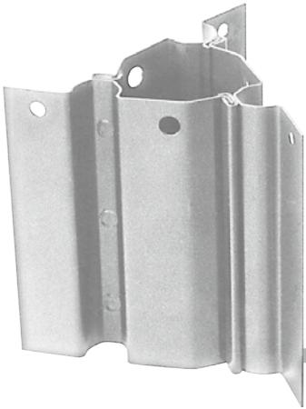
ポールアンカー ルーツ (以下、本製品) は、地上で組み立てた 3 枚の抵抗板を順次、地中に打ち込んだ後、その中心部に柱を建て込み支持するものです。従来工法のコンクリート基礎は、基礎幅より大きく掘削し埋め戻しますが、本製品は、基礎中心部の限られたスペースのみ掘削となります。そのため、本製品は、本来の地盤が有している地耐力を有効に利用することで、省スペース設置が可能となります。
